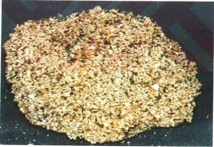
Şekil 4.52. Linyit numunelerinin akışkan yatak yanma sürecinde oluşan aglomere kütlelerin fotoğrafları: a)Beypazarı, b)Çan, c)Kısırakdere (YM: kum), d)Kısırakdere (YM: dolomit), e)Tunçbilek ve f)Yatağan. (devam)
