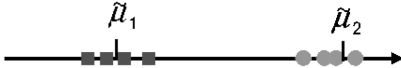
Şekil 2.10 : J(v) 'yi maksimum yapan v doğrultusu ve örneklerin bu doğrultu üzerindeki izdüşümleri.
