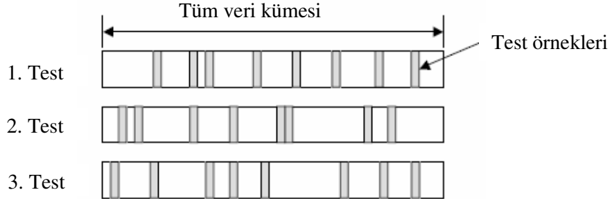
Şekil 3.1 : Örnek kümesinin rastgele alt örnekleme yöntemi ile farklı sayılarda test kümesi ve eğitim kümesi olarak ayrılması.
