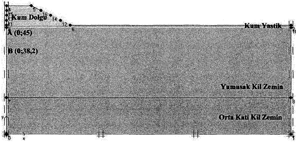
Şekil 5.11 2 m arayla geotekstil uygulanan dolgunun 1 m'lik kum yastık üzerine oturtulması
