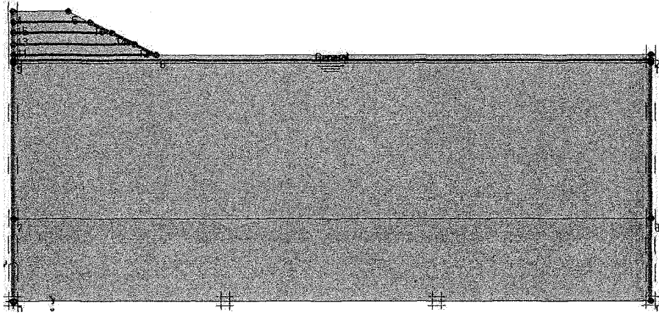
Şekil 5.12 8 m'lik kum dolgu ve kil zeminin sınır koşulları
