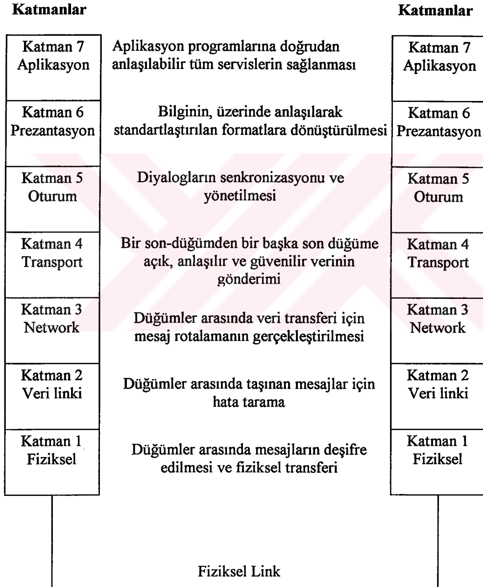
Şekil 2.4 : OSI Referans Modeli
