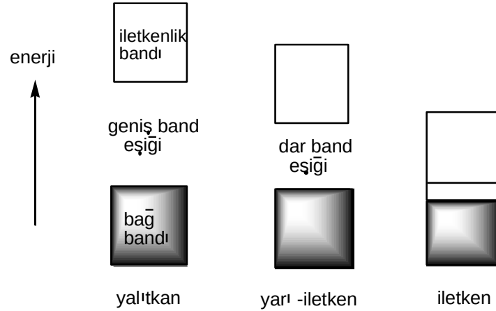
Şekil 2.7. Yalıtkan, yarı-iletken ve iletken maddelerde band aralığı
