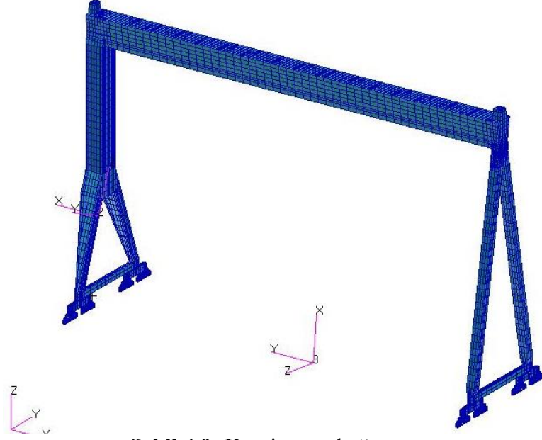
Şekil 4.9: Krenin genel ağ yapısı katı modelinin izoparametrik görünüşü -1
