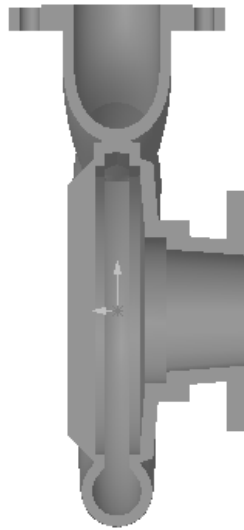
Şekil 3.9: Salyangoz Meridyonel Kesiti
