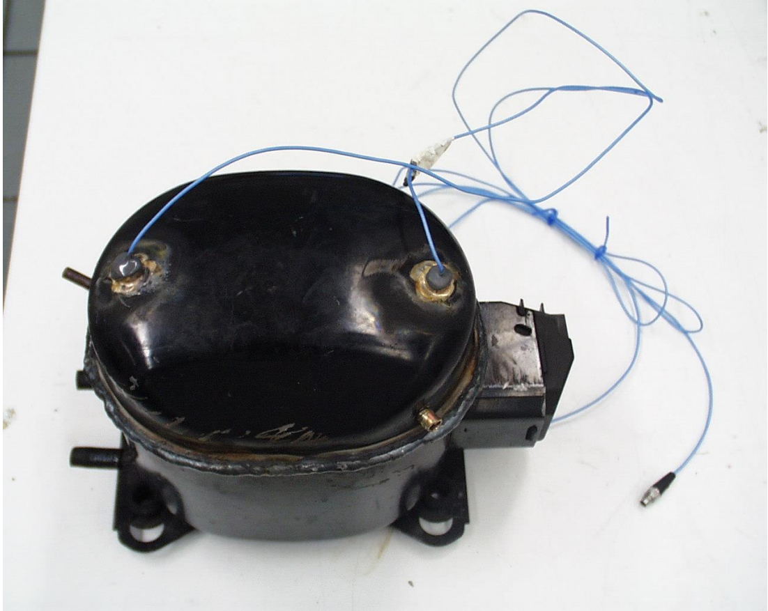
řekil 5.5 Kalorimetre testi ii hazır kompres6r
