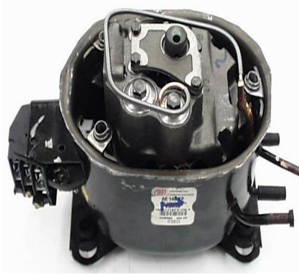
Şekil 3.14 Kompresör ve muhafazasının fotoğrafı
