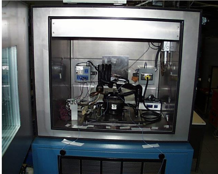
Şekil 5.7 (a) Kalorimetre test sistemi
