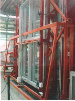
Şekil 7.2. Deney numunesinin şantiye ve proje şartlarını sağlaması amacıyla tasarlanmış çelik ile düzeysel deney takımının üzerine oturtulması
