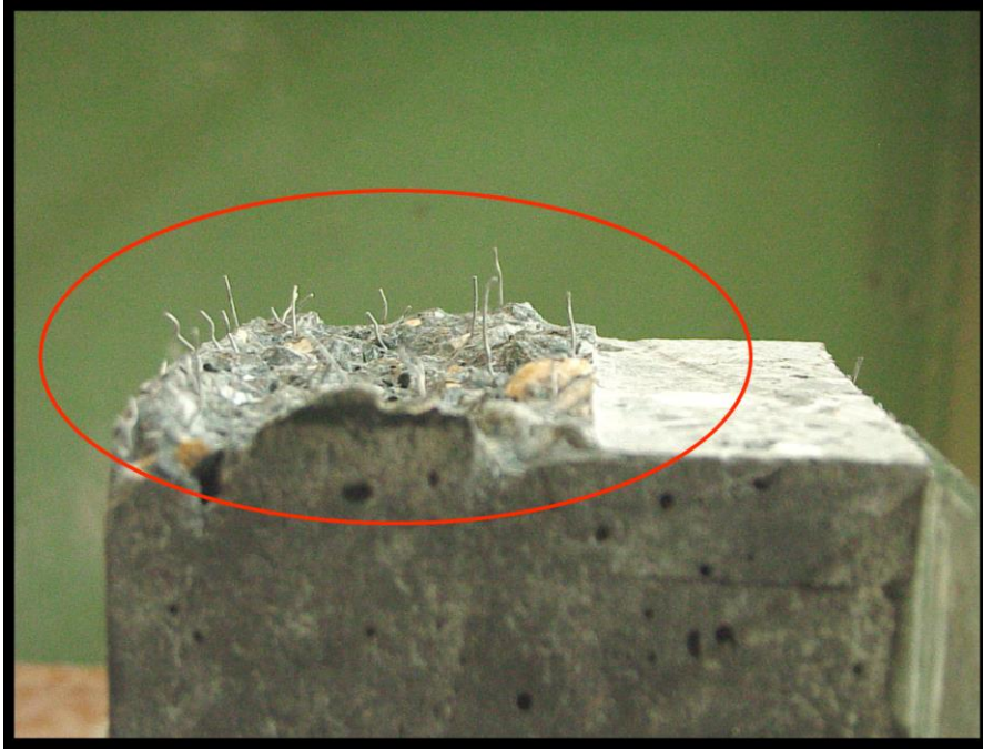
Ek Şekil D1. Kiriş Numunelerde Çelik Tellerin Sıyrılması
