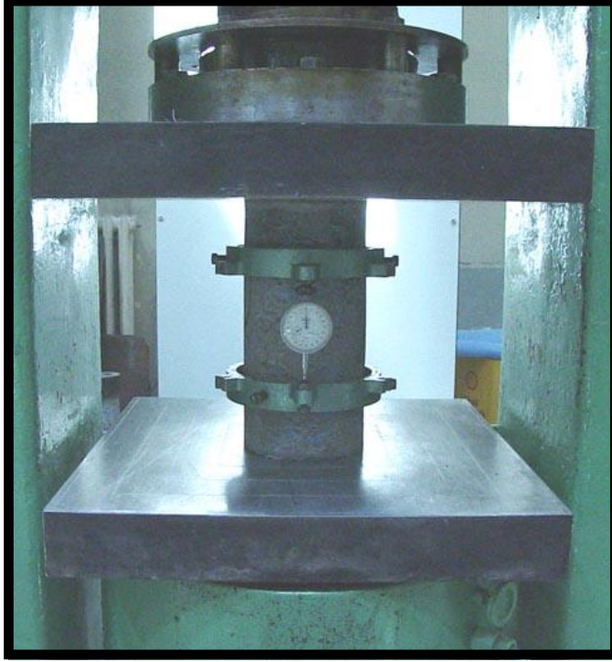
Ek Şekil A1. Silindir Basınç Deneyi Düzenegi
