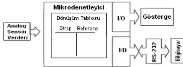
Şekil 5.6: Tablo tutma yöntemi için kullanılan sistemin blok diyagramı
