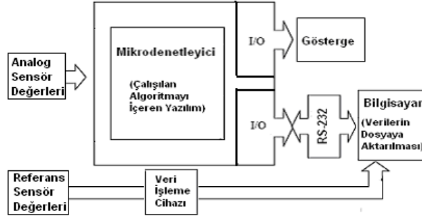
Şekil 5.1: Veri depolama sisteminin genel yapısı
