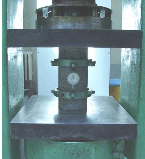
Şekil 3.2 Silindir Basınç Dayanımı ve Eksenel Şekil Değiştirme Deneyi
