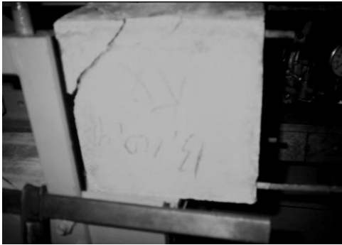
Şekil 4.4. Eğik çatlaklı kırılma biçimi (Kırılma tipi 3)
