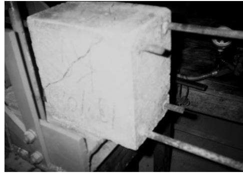
Şekil 4.4. Eğik çatlaklı kırılma biçimi (Kırılma tipi 3)
