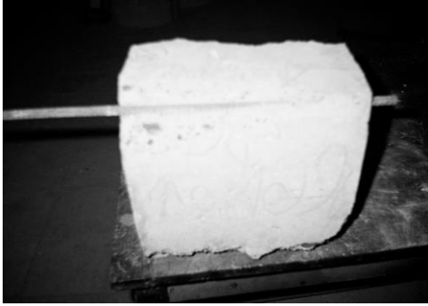
Şekil 4.3. Köşeden parça kopmalı kırılma biçimi (Kırılma tipi 2)
