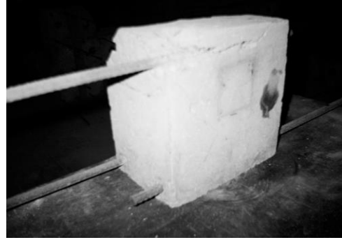
Şekil 4.3. Köşeden parça kopmalı kırılma biçimi (Kırılma tipi 2)
