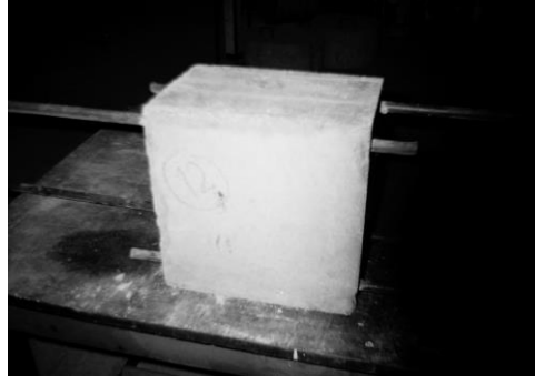
Şekil 4.2. Sıyrılma şeklinde ayrılma biçimi (Kırılma tipi 1)
