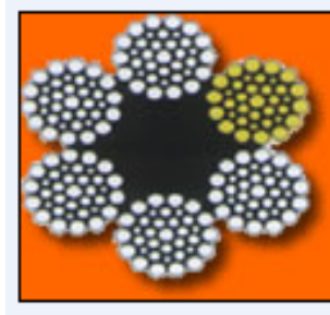
Şekil 3.39 Çelik Halatların Yapısı
