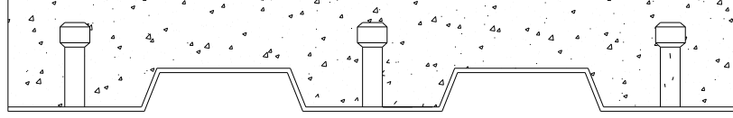
Şekil 3.13 Kompozit Döşeme Beton-Çelik Bağlantı Tipi
