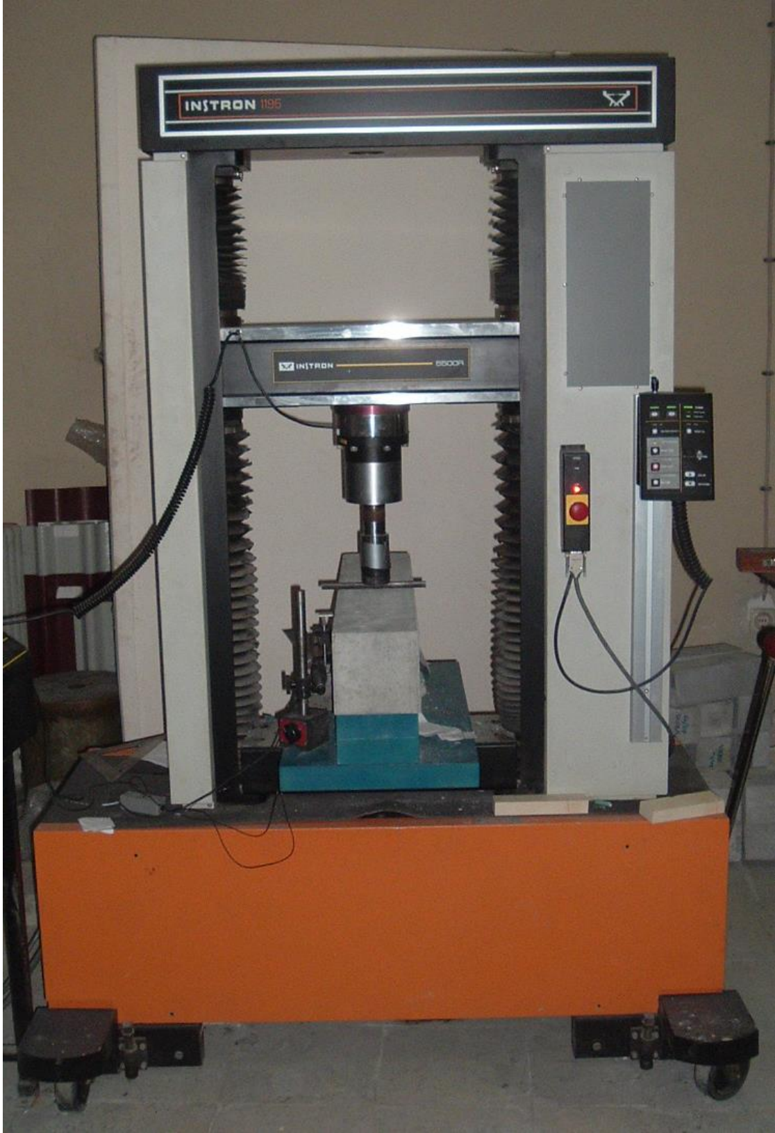
Şekil E.5 Prizma numuneler üzerinde yapılan üç noktalı eğilme deneyi
