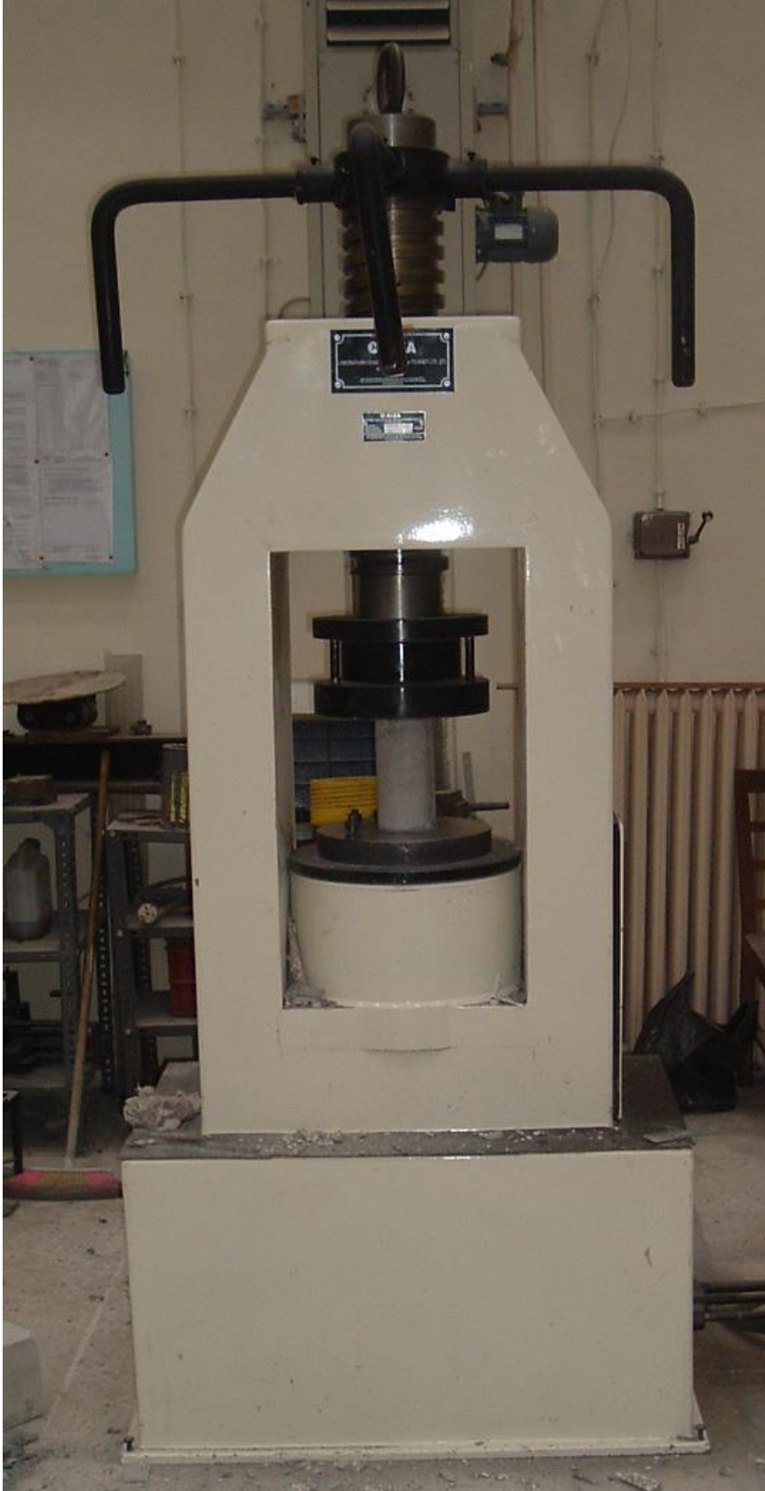
Şekil E.2 Silindir numuneler üzerinde yapılan basınç deneyi
