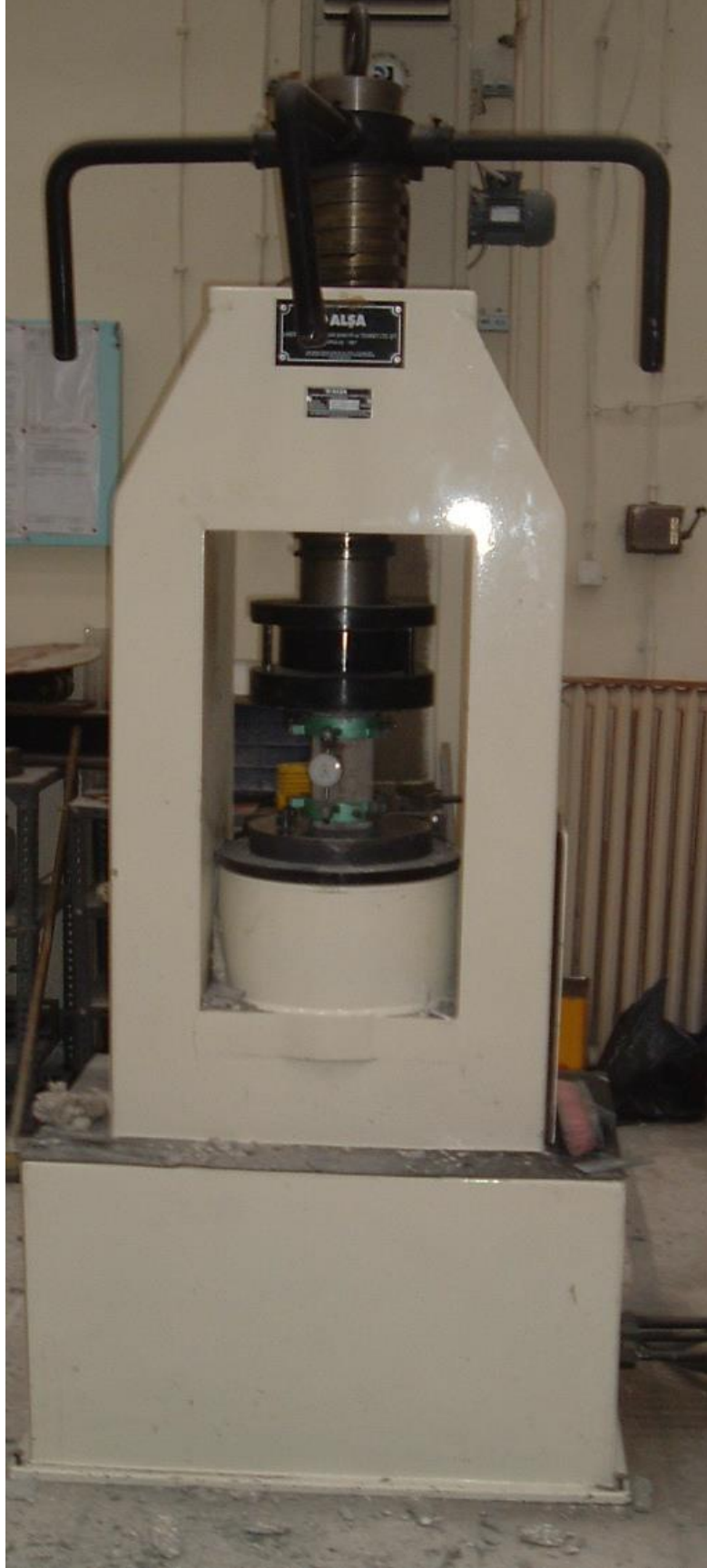
Şekil E.3 Silindir numuneler üzerinde yapılan elastisite modülü deneyi
