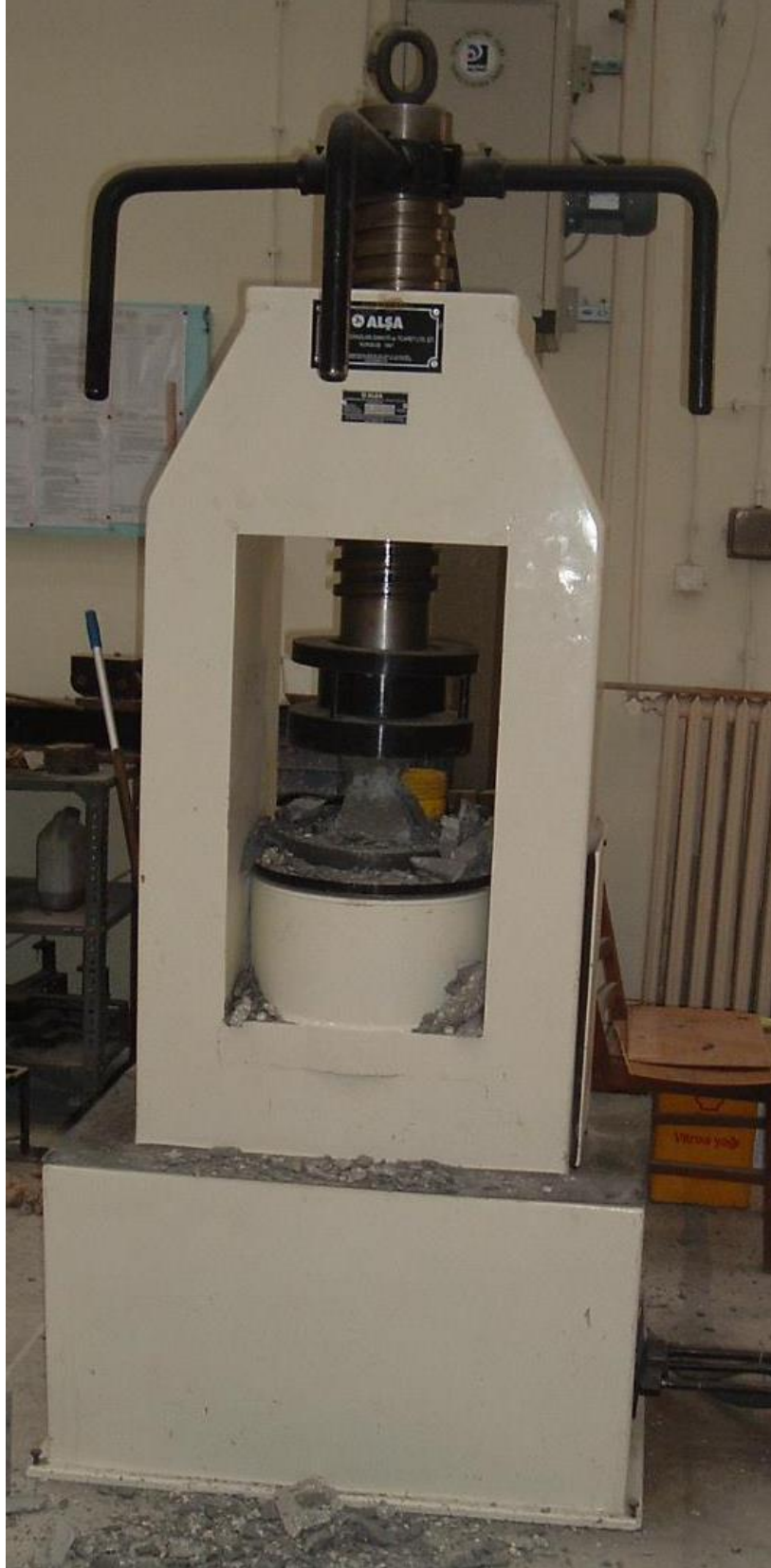
Şekil E.1 K p numuneler  zerinde yapılan basınc  deneyi
