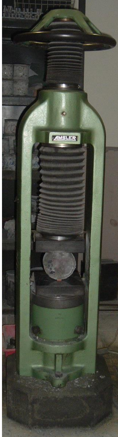
Şekil E.4 Disk numuneler üzerinde yapılan yarma çekme deneyi
