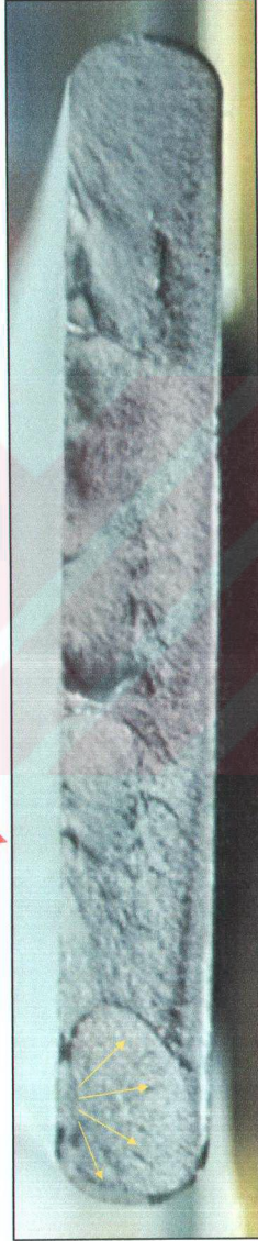
Şekil 6.5b Kırık detayı. Kırık başlangıç noktaları, çatlak ilerlemeleri ve gevrek kırılma bölgesi görülebilmektedir.
