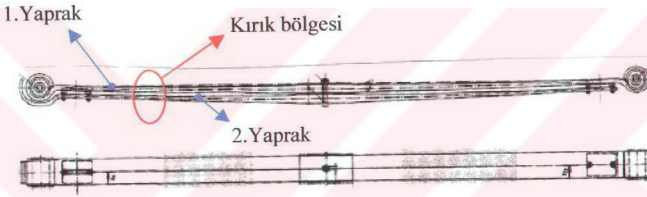
Şekil 6.3b Kırık bölgesinin yay üzerindeki konumu.
