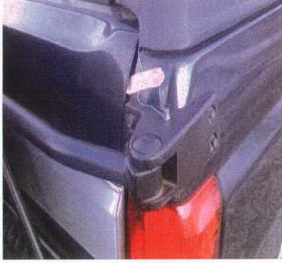
Şekil 3.7 Ford Branco'nun bazı bölgelerindeki strain gagelerin gösterimi
