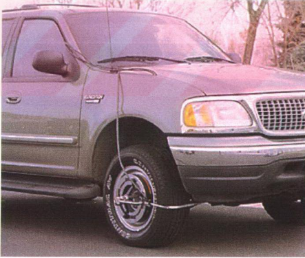
Şekil 3.11 Bir taşıt üzerindeki kuvvet kaptörü
