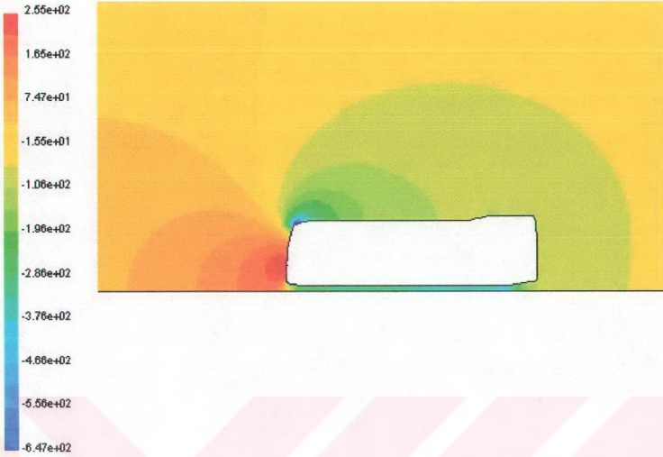
Şekil 7.19: Otobüsün yakın çevresindeki eş statik basınç büyüklüğü dağılımı eğrileri (KN 21).
