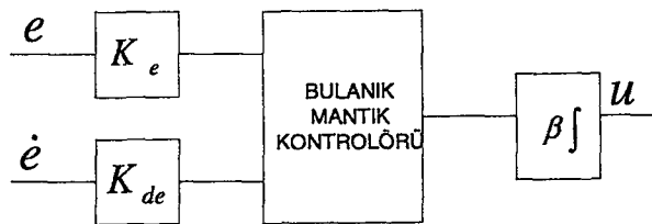
Şekil 4.3 Bulanık PI tipi kontrolöre ait blok gösterimi
