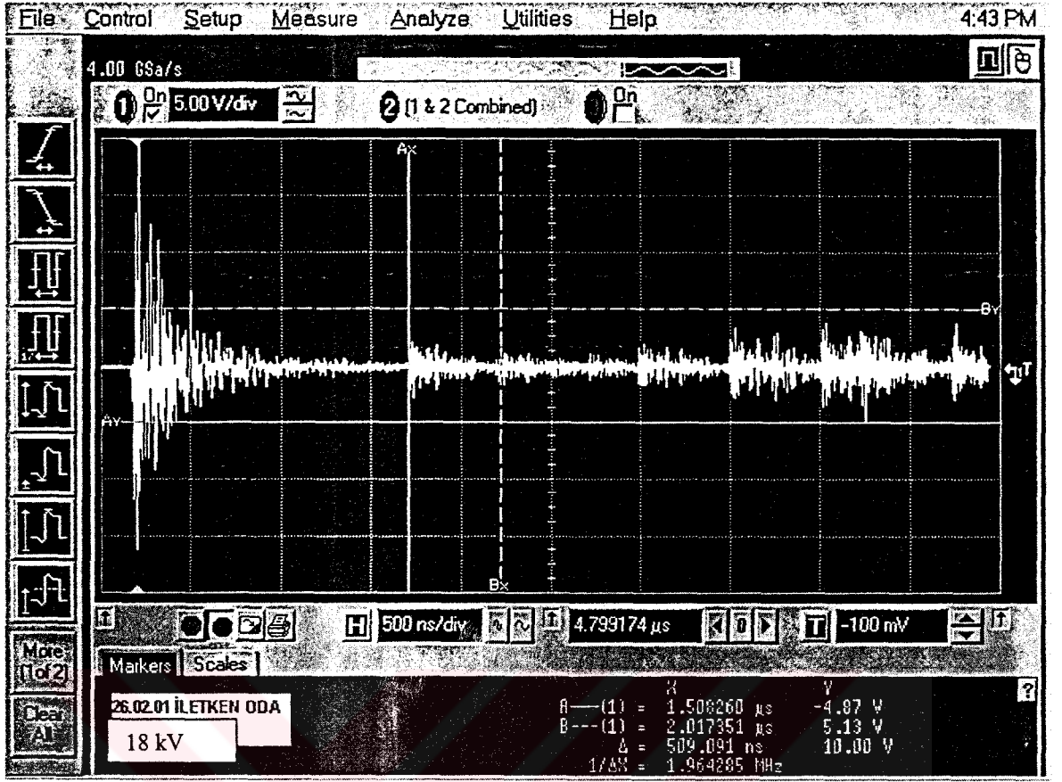
Şekil 5.4 İletken Odada Yapılan RE Deneyi Çıkış Dalga Şekli
