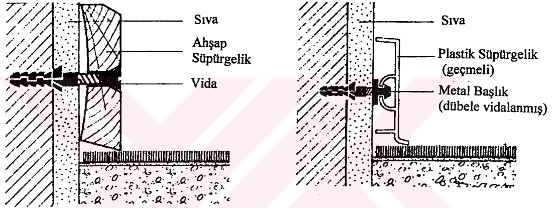
Şekil 3.1. Ahşap ve plastik süpürgelik uygulaması [8, s.269].
