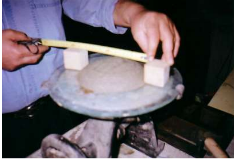
Şekil 5.3. Kıvam Tayini Deneyi
