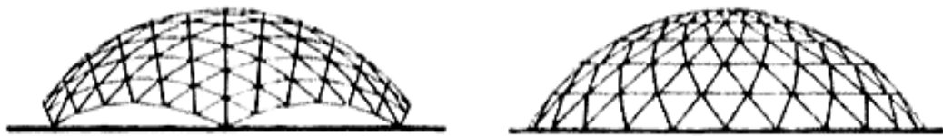
Şekil 3.9 Kabuk yüzeylerinin zemine yük aktarma şekilleri
