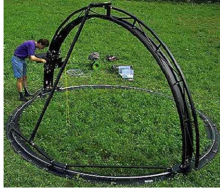
Şekil 6.28 : Goniometre aleti (NASA Web Sayfası-3)
