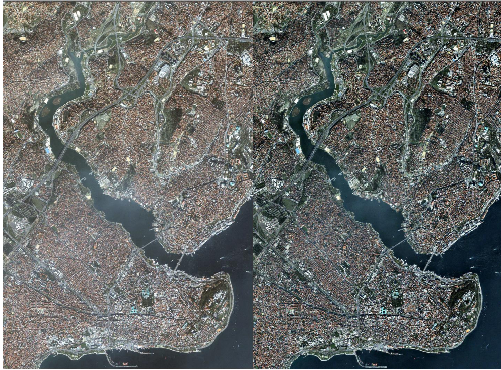
Şekil A.5 : 25-10-2004 tarihli IKONOS görüntüsü (Atmosferik düzeltme önce ve sonrası)
