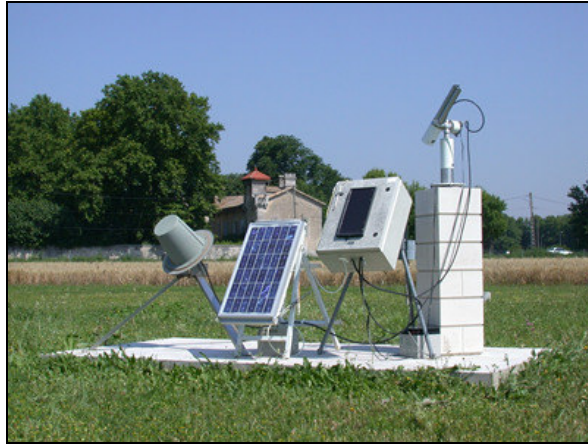
Şekil 6.15 : Güneş fotometre istasyonu (NASA Web sayfası -2)
