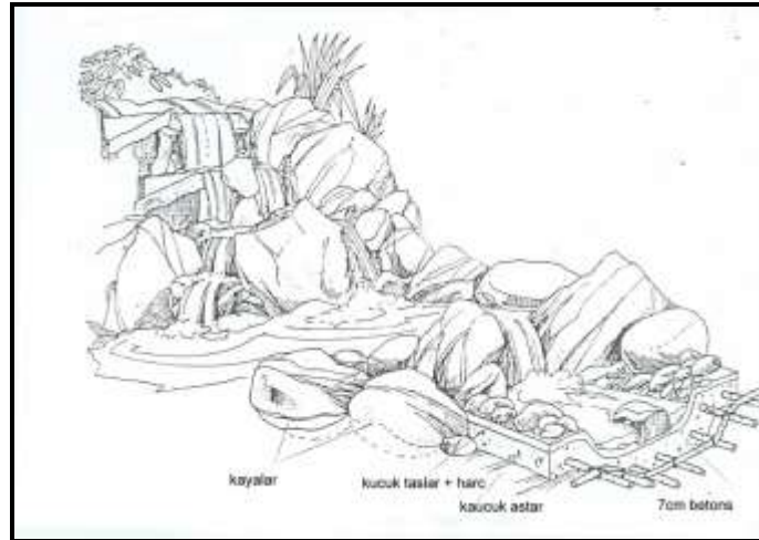
Şekil 4.76 Yapay şelale uygulama tekniği
