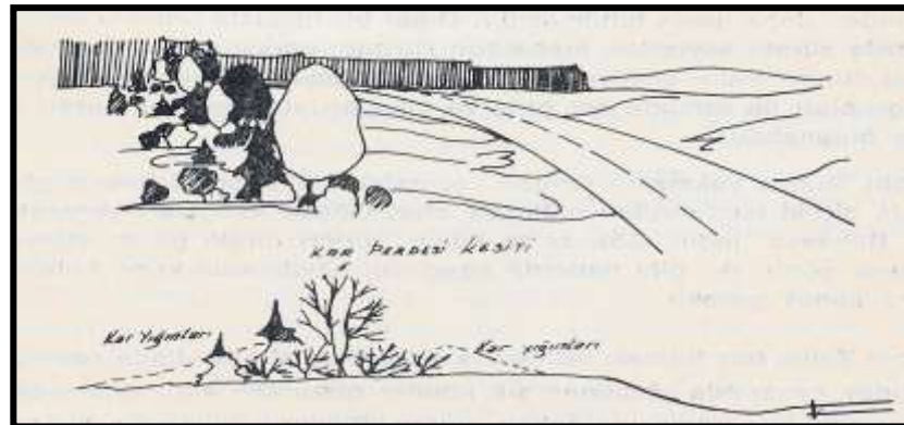
Şekil 3.20. Bitkisel kar perdesi kesiti ve görünüşü (Lorenz, 1975)
