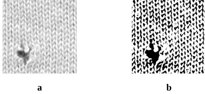
Şekil 3.3 : Eşikleme işleminin kumaş görüntüsüne uygulanması; a) Orijinal kumaş görüntüsü (gri seviyeli), b) Eşikleme işlemi uygulanmış görüntü (siyah-beyaz)
