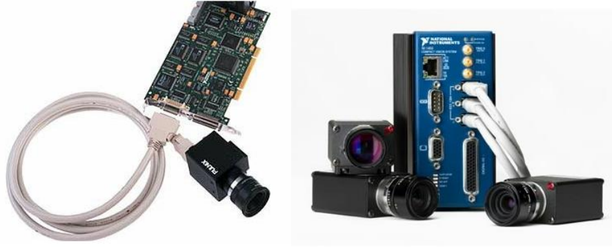
Şekil 6.2 : NI firmasının görüntü yakalama kartı ve Kompakt Makine Görüşü sistemi
