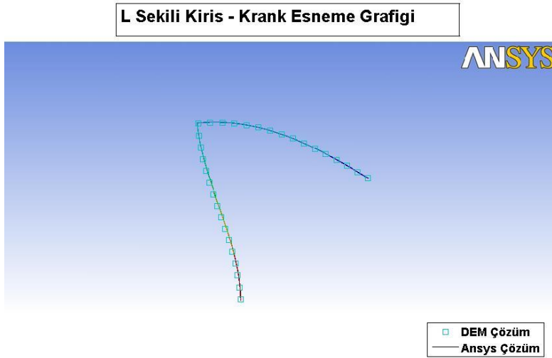
Şekil 4.23: L tipi kirişin ucundan krank bağlı. Krank açısı 270°.
