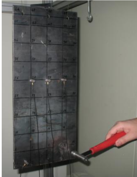
Şekil 4.33 Modal Çekiç ile Tahrik Edilen Düz Plaka
