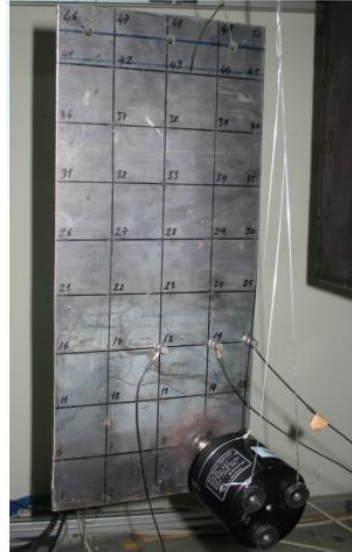
Şekil 4.34 Sarsıcı ile Tahrik Edilen Düz Plaka
