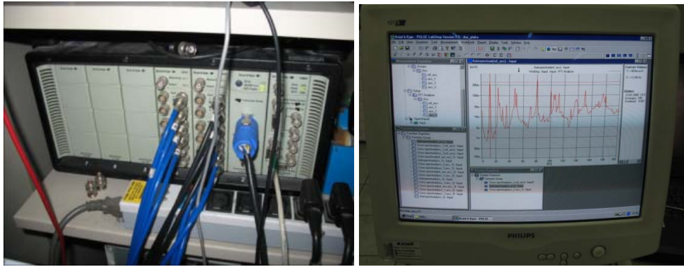
Şekil 4.2 Bruel-Kjaer PULSE Analizörü ve yazılımı
