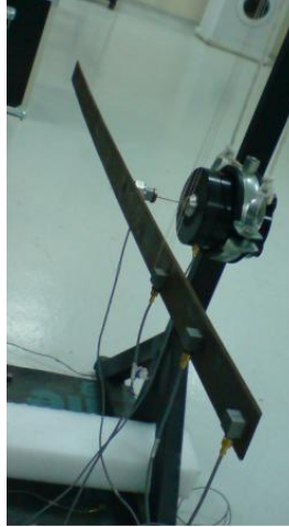
Şekil 4.16 Sarsıcı ile Tahrik Edilen Düz Kiriş
