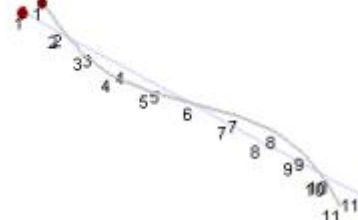
Şekil 4.19 Rasgele Tahrik Sonucu Elde Edilen 2. Modun Karşılaştırılması
