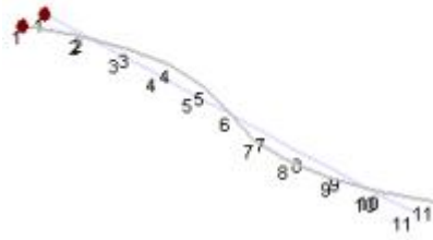
Şekil 4.19 Rasgele Tahrik Sonucu Elde Edilen 2. Modun Karşılaştırılması
