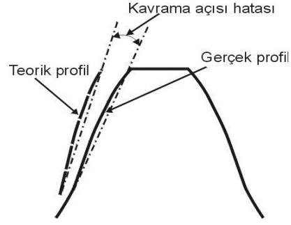
Şekil 2.11 Kavrama açısı hatası
