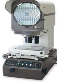
Şekil 3.4 Profil projeksiyon cihazı (Mitutoyo PJ-H3000F)
