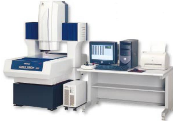
Şekil 3.7 Görüntü işleme sistemi (Mitutoyo Quick Vision 404)
