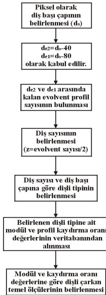
Şekil 4.14 Dişli parametrelerinin belirlenmesi
