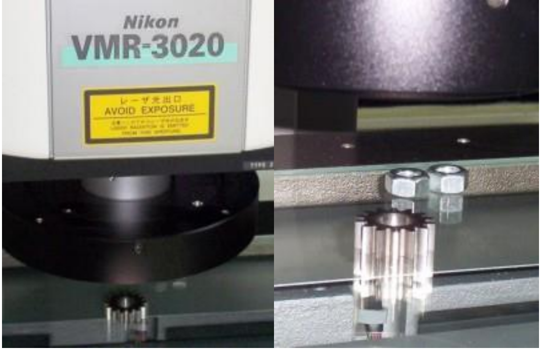
Şekil 5.8 Servo sistem ile dişli çarkın görüntüsünün alınması
