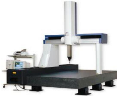
Şekil 3.5 Koordinat ölçüm cihazı (Crysta-Aqex C series)
