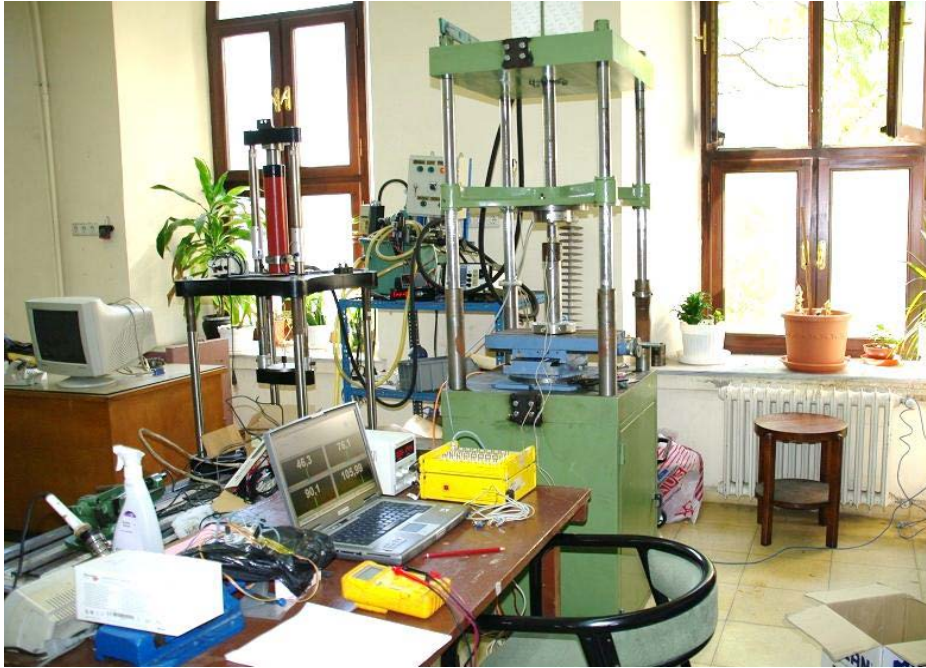
řekil 5.5 : zel tasarım servo hidrolik dinamik ūniversal test cihazı ve veri toplama sisteminin genel gūrūnūmū.
