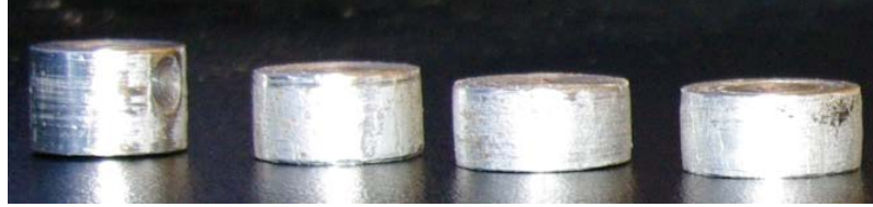
Şekil 5.26 : Farklı basınçlarla fırlatılan merminin E1 tipi numunede oluşturduğu deformasyonun görünümü.
