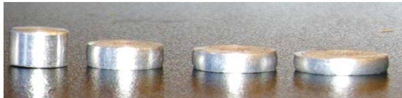
Şekil 5.27 : Farklı hızlarda fırlatılan merminin E2 tipi numunede oluşturduğu deformasyonun görünümü.
