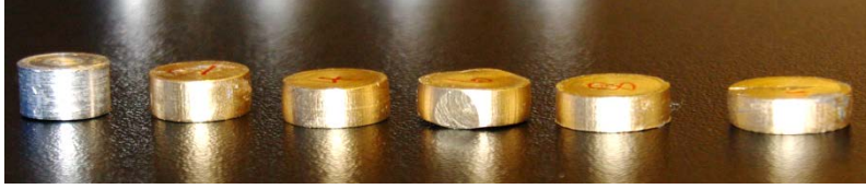
Şekil 5.28 : Farklı hızlarda fırlatılan merminin E3 tipi numunede oluşturduğu deformasyonun görünümü.
