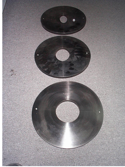
Şekil 5.3. Hidrostatik şişirme testinde kullanılan kalıp fotoğrafları
