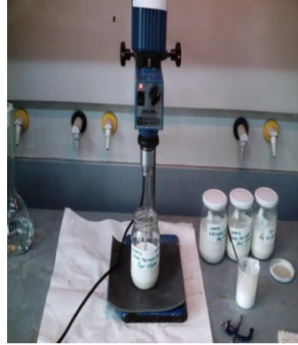
Şekil 2.4 : Y.T.Ü. Anorganik Kimya Laboratuvarında bulunan IKA RW20 Model Mekanik Karıştırıcı
