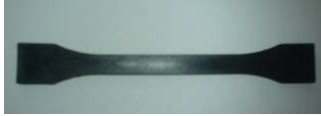
Şekil 4.2 : Enjeksiyonla kalıplanmış çekme sürünmesi numunesi
