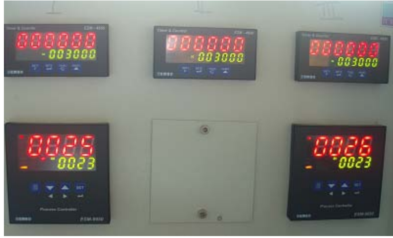
Şekil 4.8 : Çekme sürünmesi testlerinde kullanılan uzama ve sıcaklık göstergeleri
