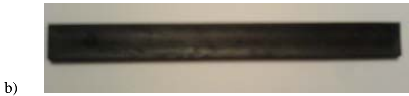
Şekil 4.3 : Enjeksiyonla kalıplanmış eğme sürünmesi numunesi
