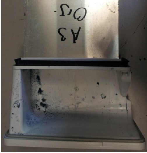
Şekil 3.6 : Yıkama öncesi ve sonrası hava yönlendirici parça görünüm.
