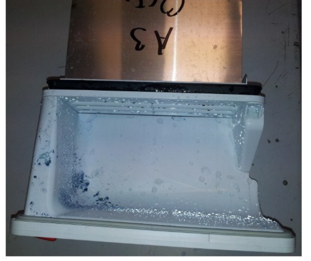
Şekil 3.6 : Yıkama öncesi ve sonrası hava yönlendirici parça görünüm.
