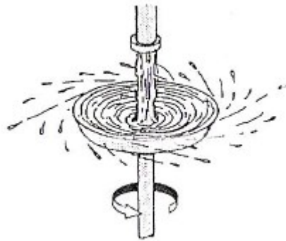
Şekil 2.10 : Sıvıya dairesel hareket verilmesi.
