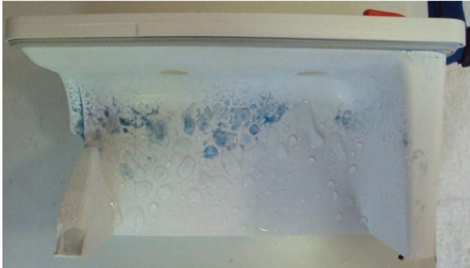
Şekil 3.11 : Yıkama sonrası hava yönlendirici görünümü.
