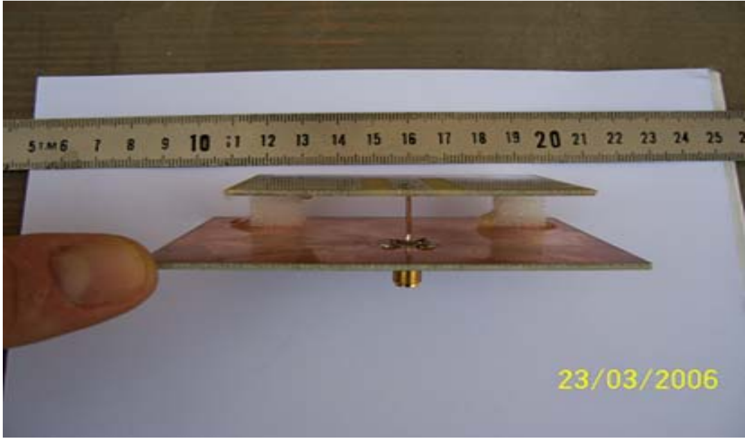
Şekil 3.2.9. 2.2 ve 2.45 GHz frekanslarında Çalışan E Şeklindeki Yama Antenin Yandan fotoğrafı
