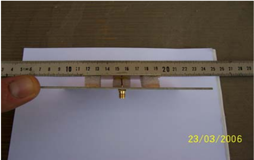
Şekil 3.2.21. - L Probe Beslemeli Yama Antenin Yandan Görünüşü
