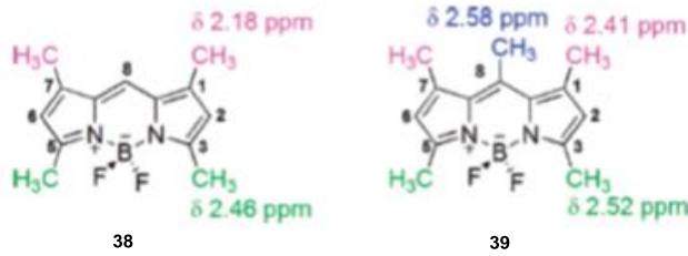
Şekil 1.16 : BODIPY Çekirdeğindeki Metil Hidrojenlerinin 1 H-NMR kaymaları.
