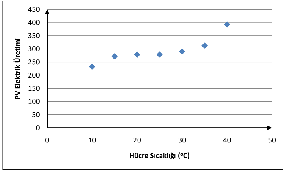
Şekil 4.61 : Şubat ayında ortalamadan 1 standart sapma büyük PV elektrik üretimi ve hücre sıcaklığı ilişkisi.
