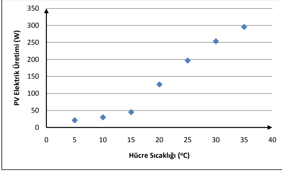
Şekil 4.55 : Şubat ayında hücre sıcaklığı ve PV elektrik üretimi ilişkisi.
