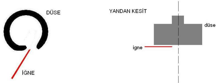
Şekil 4.2 : Ekstruderde kullanılan düze şekli ve iğnenin konumu
