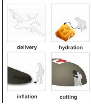
Şekil 4.22 Concrete Canvas kurulum döngüsü
