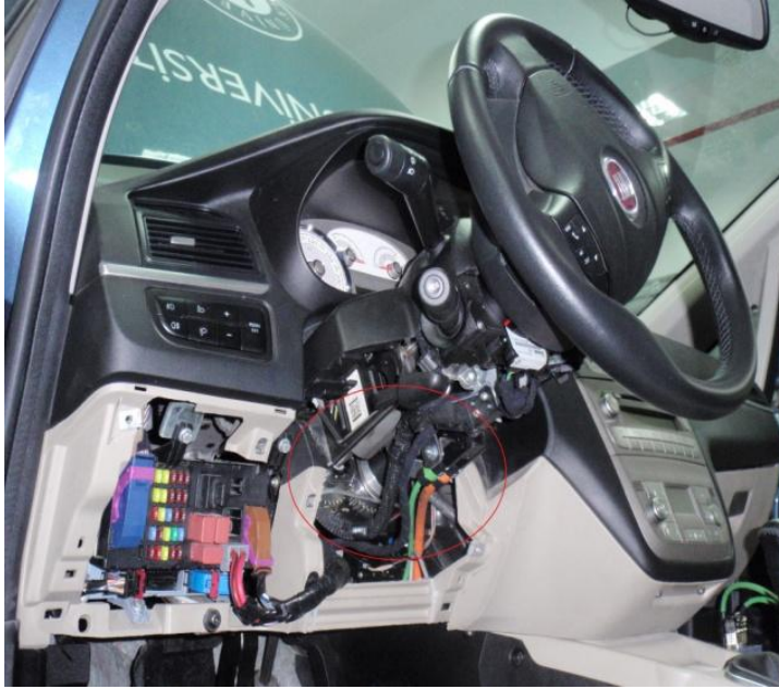
Şekil 2.2 : Servo motorun montajı.
