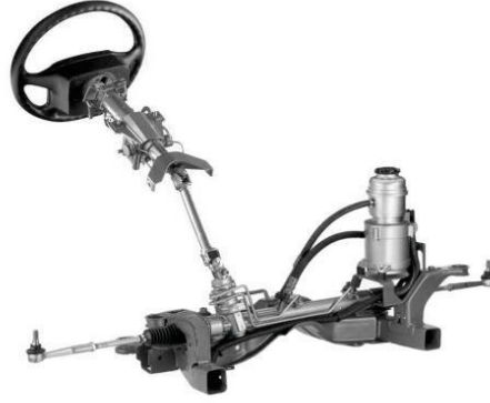
Şekil 4.21 : Hidro elektrik güç takviyeli yönlendirme sistemi [20].
