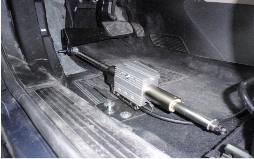
Şekil 2.6 : Lineer motorun fren pedalına monte edilişi.
