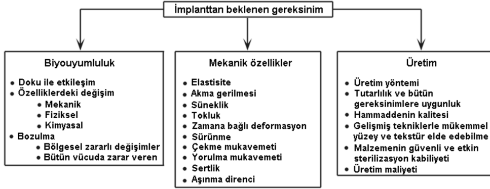
Şekil 2.1: İmplant malzemeden beklenen özellikler[14]
