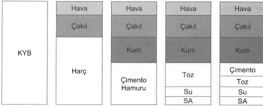
Şekil 1: Kendiliğinden Yerleşen Beton Karışım Kompozisyonu
