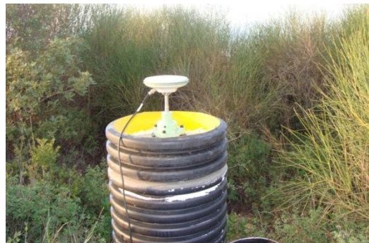
Şekil 7.5 : Deformasyon noktalarının pilye tesisi.
