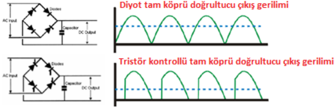
Şekil 2.57 : Diyot veya tristör kontrollü tam köprü doğrultucu ve DC çıkış.
