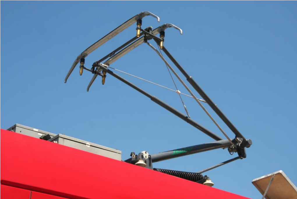
Şekil 2.23 : Trenin çatısına yerleştirilmiş pantograf.
