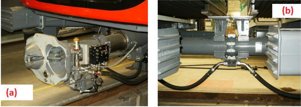
Şekil 3.17 : (a) Otomatik kuplör. (b) Sabit kuplör [7].
