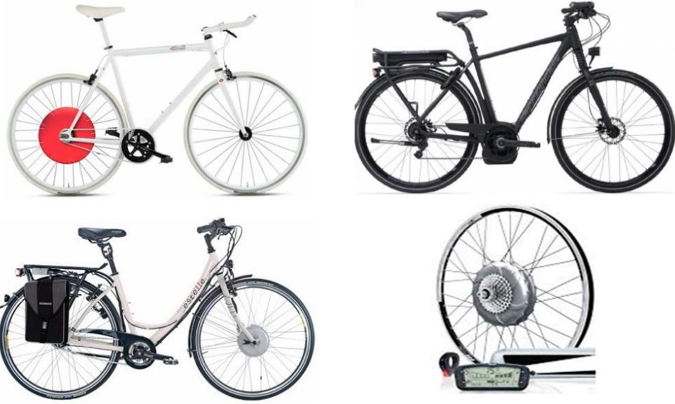
Şekil 1.9 : Örnek elektrikli bisiklet sistemleri- Arka motorlu sistem (sol üstte) [22], motoru pedalda olan sistem (sağ üstte) [23], ön motorlu sistem (sol altta) [24], elektrikli bisiklet dönüşüm kiti (sağ altta) [25].
