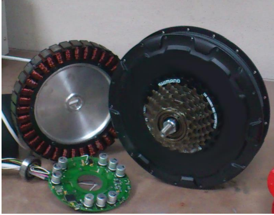
Şekil 3.3 : Motor imalatının tamamlanması.
