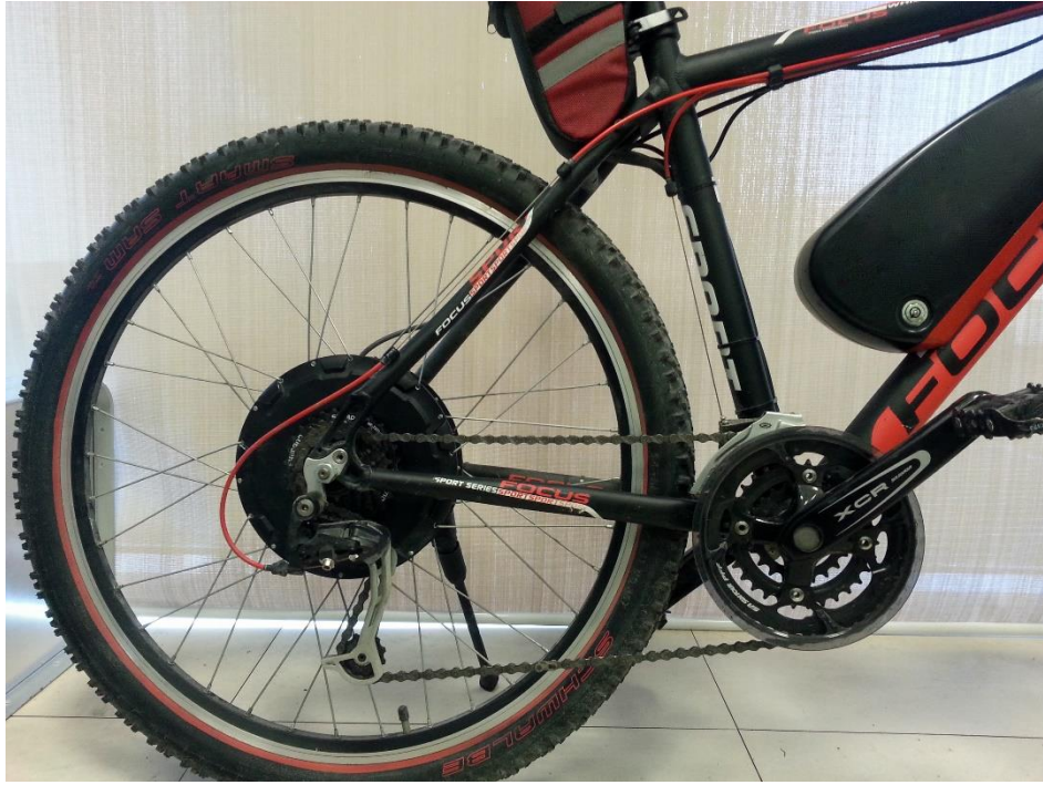
Şekil 3.17 : Motorun bisiklete monte edilmesi.
