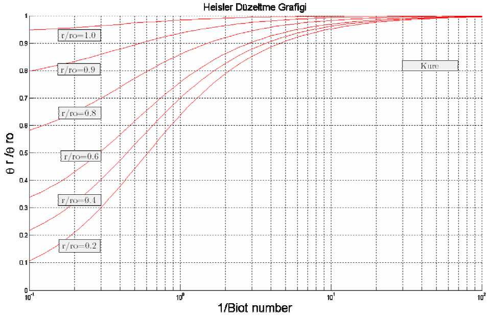
Şekil 2.6: MATLAB fonksiyonları ile üretilen küre için Heisler düzeltme grafiği
