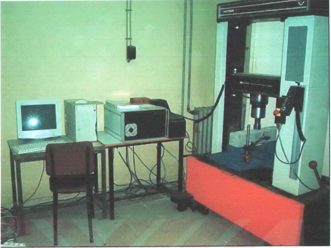
Şekil J.3. Deplasman kontrollü deney aleti (Instron 5500R).
