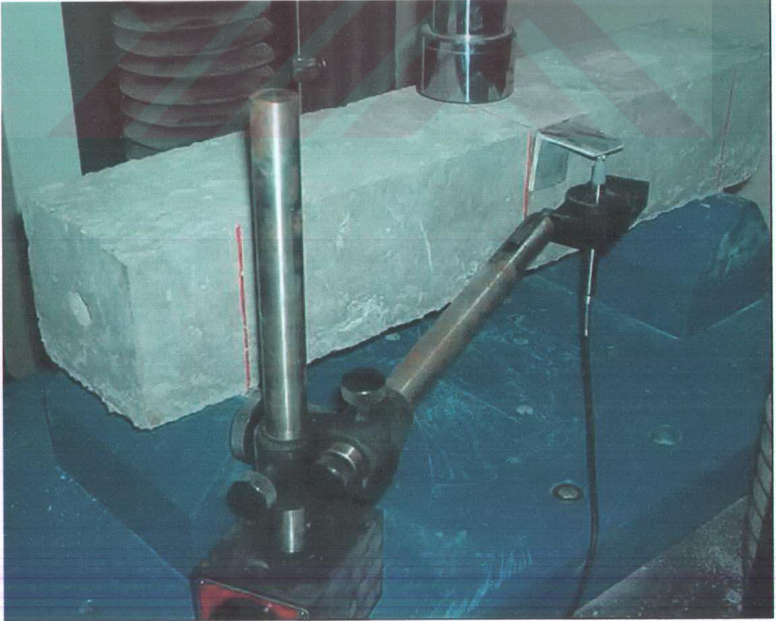
Şekil J.4. Çentikli yalın beton kiriş için üç noktalı eğilme deneyi düzeneği.
